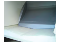
2 Flüssigkeitstank im Aufbauboden 3 Kiefförmige Boden- gruppe mit seitlichen Führungen für das Ausstoßschild
