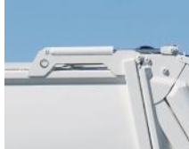
4 Heckteilzylinder auf den Dach
