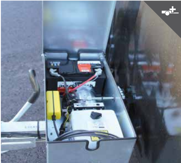
Leistungsstarke Elektrohydraulik wasser- und schmutzgeschützt montiert
