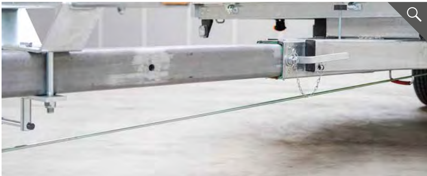
Zugdeichsel einfach ohne Werkzeug ausziehbar
