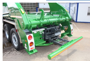
Unterfahrschutz manuell oder hydraulisch ausfahrbar
