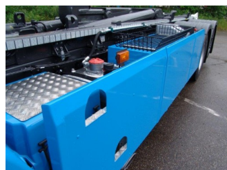
Seitliche Vollverkleidung mit integriertem Staukasten
