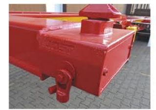
Befestigungsmethode für 40-Fuß ISO und 2x20-Fuß am vorderen Träger
