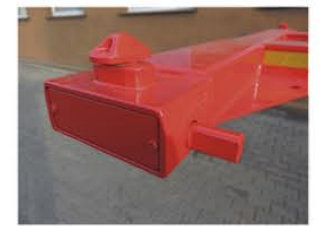
Befestigungsmethode für 40-Fuß-HC und 45-Fuß-HC am vorderen Träger
