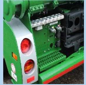
Aufstieg heckseitig mit Haltegriff und Shockabsorber-Lampenträger
