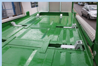
Verstellbare und versenkbare seitliche Anschläge
