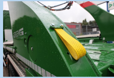
Aufstieg heckseitig mit Haltegriff und Shockabsorber-Lampenträger
