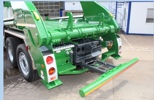
Unterfahrschutz manuell oder hydraulisch ausfahrbar
