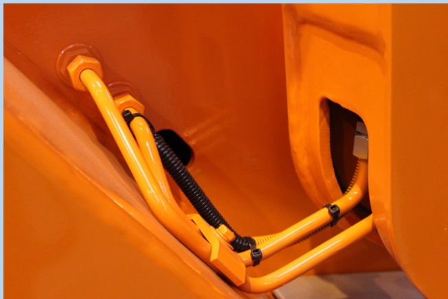
Wenig Einsatz von Hydraulikschläuchen Verschleißarme Verlegung
