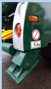
Verstellbare und versenkbare seitliche Anschläge
