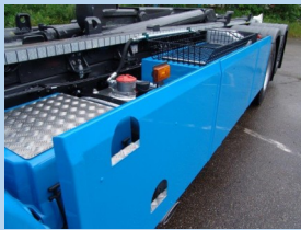
Seitliche Vollverkleidung mit integriertem Staukasten und Aufstieg
