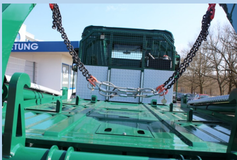
4-fach Hydraulische Behälterverriegelung
