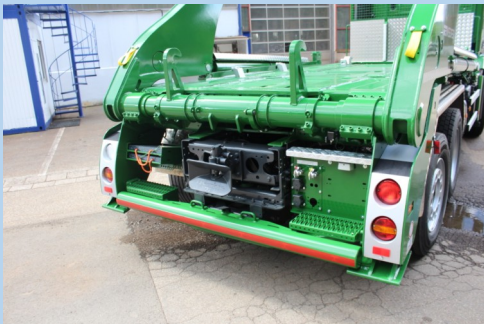
Unterfahrschutz manuell oder hydraulisch ausfahrbar
