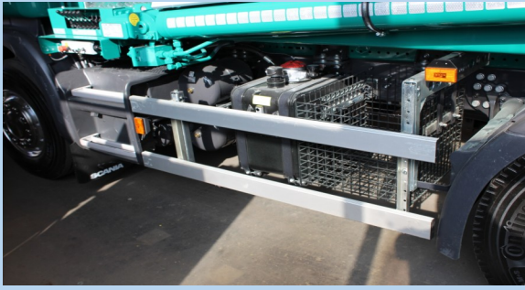
Abnehmbare seitliche Schutzvorrichtung aus Aluminium
