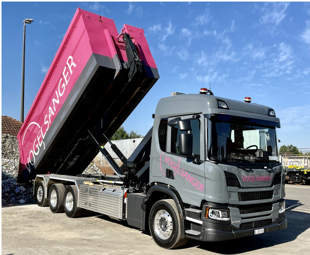
Dank Hakengerät und Frontkran kann dieser Scania äusserst flexibel als Kombi-Fahrzeug eingesetzt werden.
